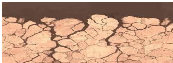
Figure I.3 : Exemple de la corrosion sous contrainte.
