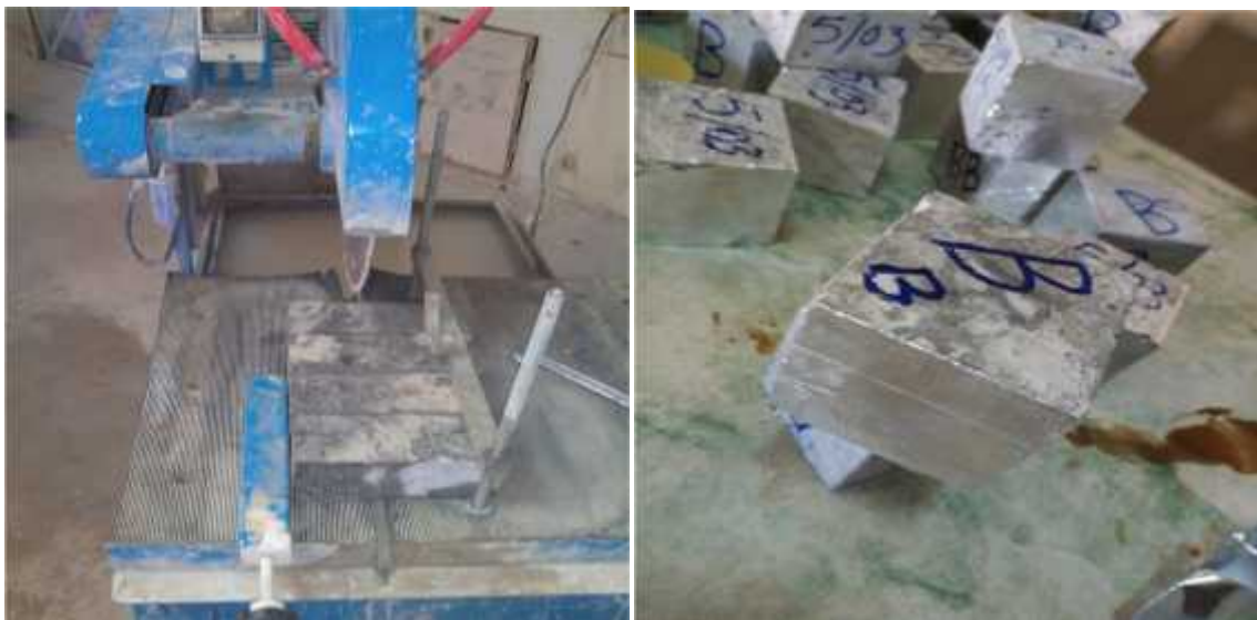
Figure II.13 : Préparation des échantillons pour l'essai de carbonatation.
