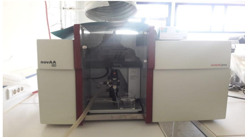
Figure II.7 Spectrophotométrie d'Absorption Atomique.
