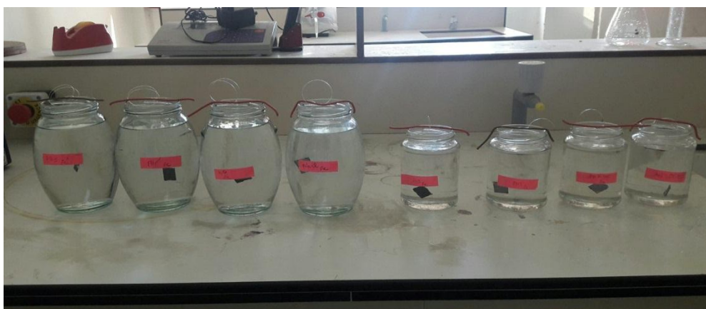
Figure II.6 : Photo du dispositif expérimental de l'immersion.
