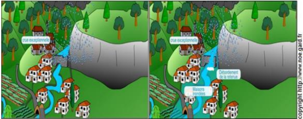
Figure 6. Inondation par débordement au-dessus de la digue (MADI . 2014 )
