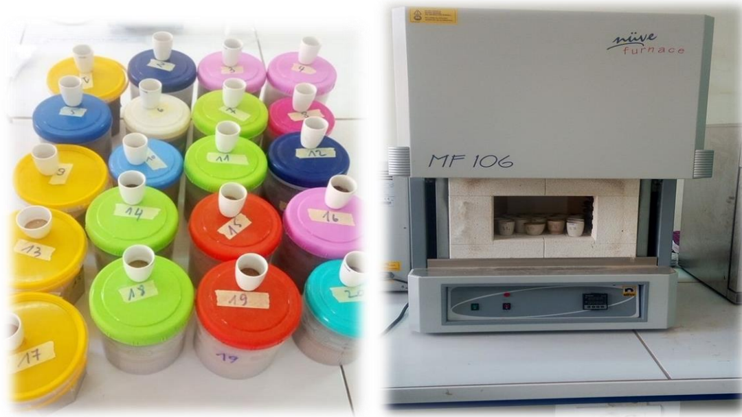
Figure 14. Séchage de 10 g du sol dans le four à moufle pendant (24h) à 105 °C.
