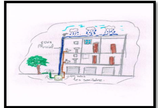
Schéma N°06 récupération de l'eau de pluie. /Source : l'étudiante
