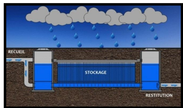
figureI-12 : schéma de stockage d'eau Source : www.hellopro.fr
