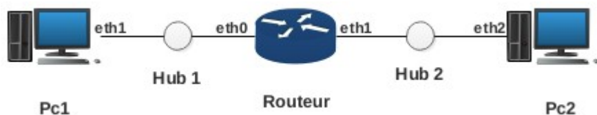
Figure II.18: Un topologie simple contenir un routeur et deux pc.
