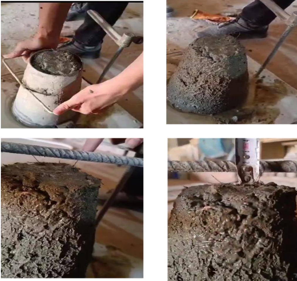
Figure 2.14: Essai d'affaissement au cône d'Abrams
