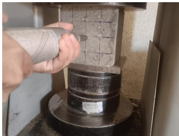
Figure 2.19 : Essai de contrôle de qualité au scléromètre
