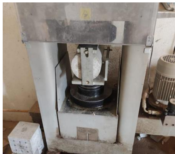
Figure 2.17 : Dispositif de l'essai de traction par fendage
