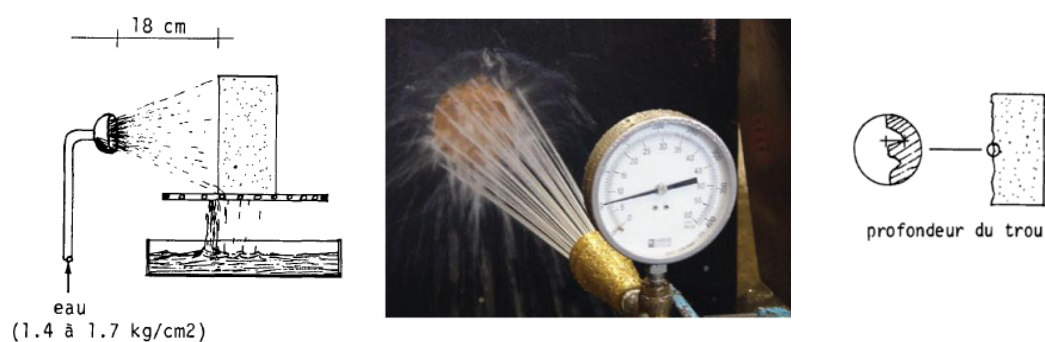
Figure 71 : Essai d'arrosage ou de dégradation accélérée de pomme de douche.
