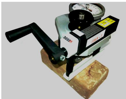
Figure 101 : Mise en place de l'échantillon dans le dispositif d'essai.
