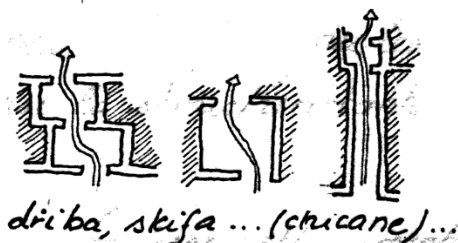
Figure 19 : Type d'accès à la maison. Source : BET Arabesques -TAKHI Belkacem – Laghouat
