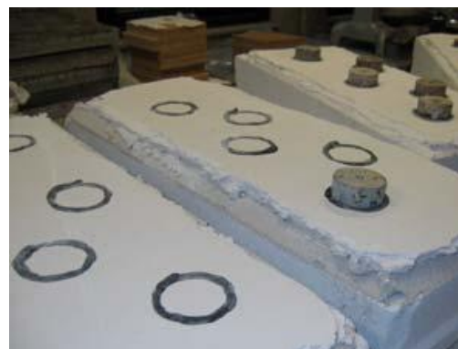
Figure 102 : Exécution de plus d'un carottage sur la même brique.
