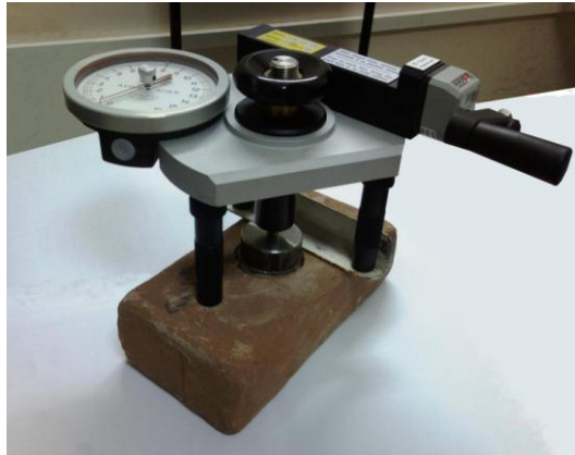
Figure 98 : Dispositif d'arrachement : L'Extractomètre.
