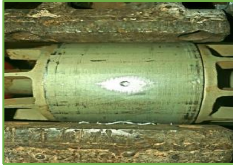
Figure 1.11: perçage de la barre rotorique. LM. Lagh
