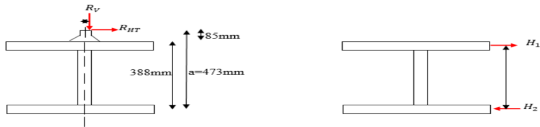
Figure V-5 : Forces horizontales et verticales appliquées sur la poutre de roulement
