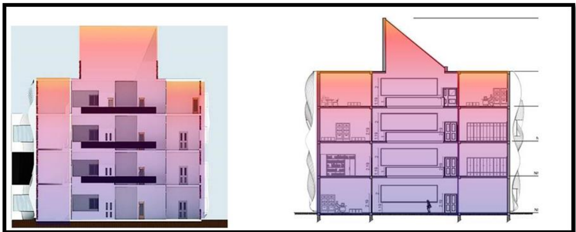
Figure V. 39 : coupe schématique présente l'ambiance thermique des atriums. Source : auteur.
