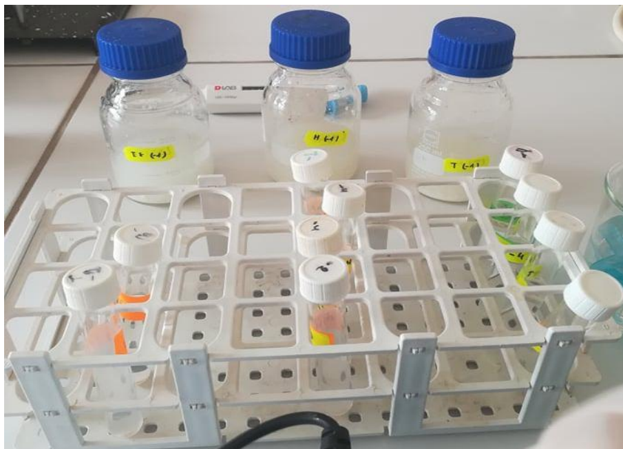
Figure N°19 : Préparation de la solution mère et des dilutions décimales (Photo originale, 2022).
