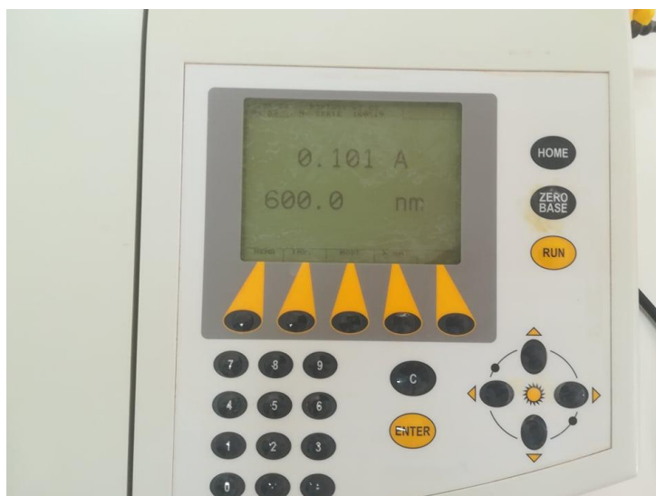
Figure N°15 : Spectrophotomètre de type THERMO SCIENTIFIC HELIOS ALPHA (UV-vis double balayage UK) (Photo originale, 2022).
