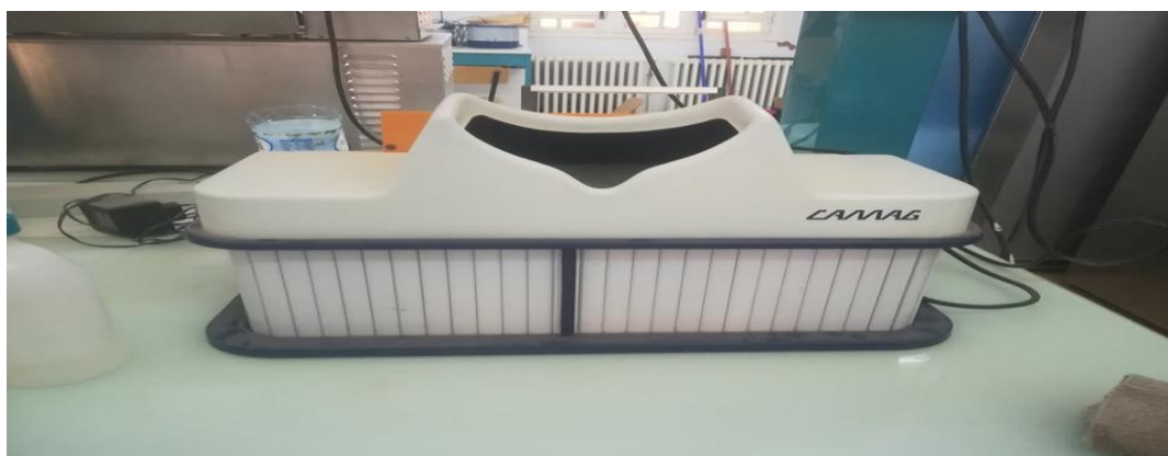
Figure N°11 : Traitement de l'extrait dans un UV-light (30 W, 50 cm distance de radiations) (Photo originale, 2022)
