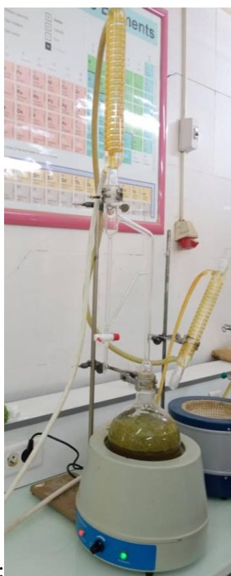
Figure N°13 : Montage d'un hydrodistillateur de type Clevenger ( Photo originale, 2022 ).
