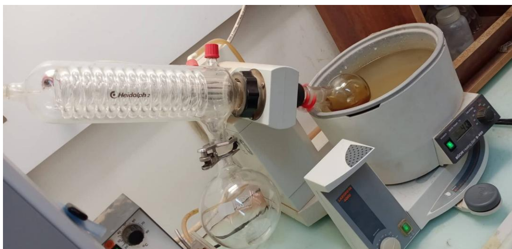
Figure N°10 : Evaporation de l'éthanol à 50°C dans un évaporateur rotatif de type Heidolph Rotary Evaporator, Laborota 4000 (Photo originale, 2022)
