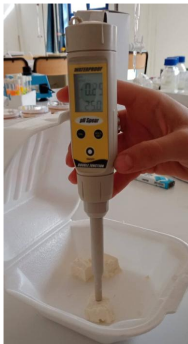
Figure N°18 : Mesure de pH Spear Food Testing sur fromage blanc ( Photo originale, 2022 ).
