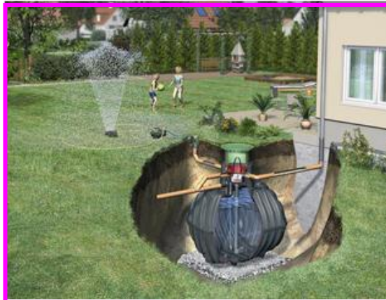
Figure.v.57: La cuve enterrée
