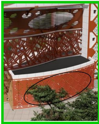
Figure.v.49 :protection par Résille extérieure : ( mouchrabia )source :auteurs
