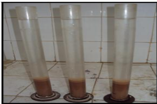
Figure II. 2: Eprouvette de mesure de l'équivalent de sable
