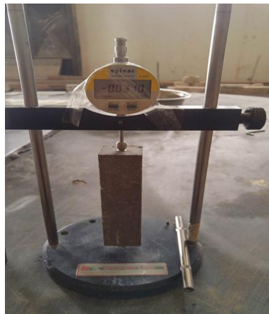
Figure II.13: Appareillage de mesure du retrait.
