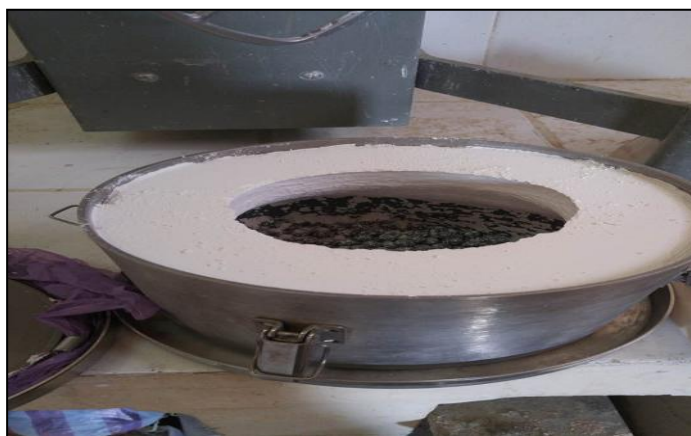
Figure II.3 : la poudre de la chaux après broyage
