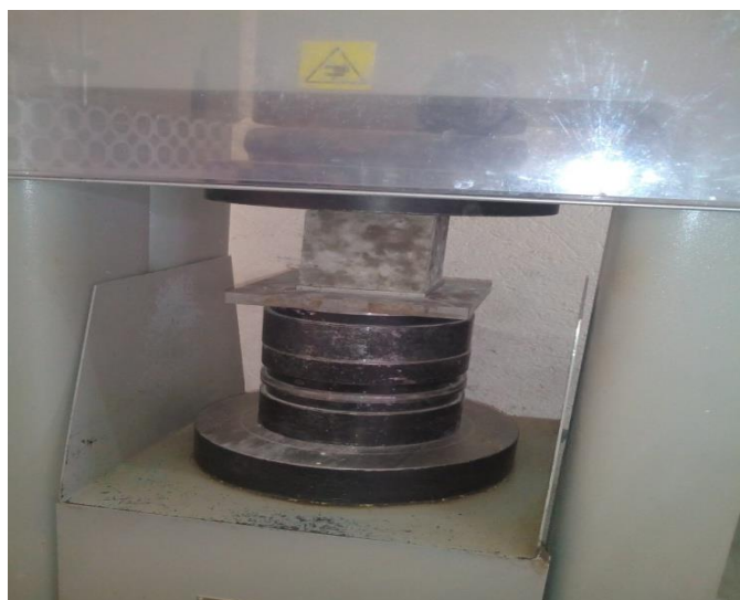
Figure II-3 : L'essai d'écrasement des spécimens
