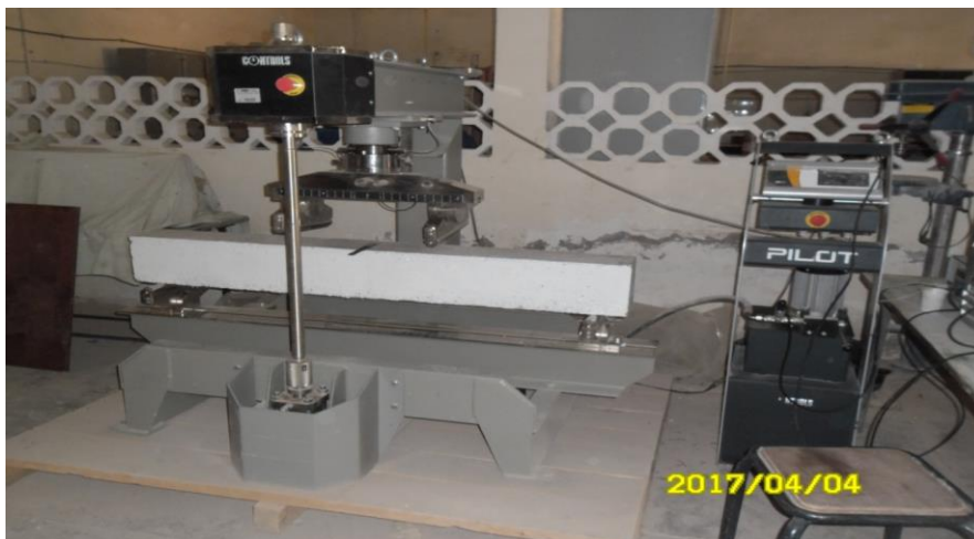
Figure II-12: Essai de flexion quatre 4 points
