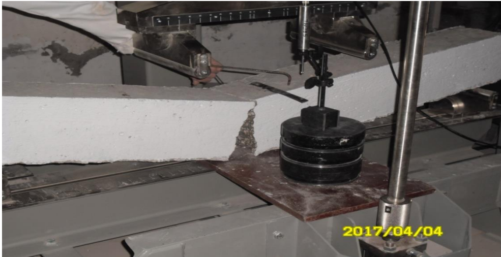
Figure II-15 : La rupture de la poutre non armée
