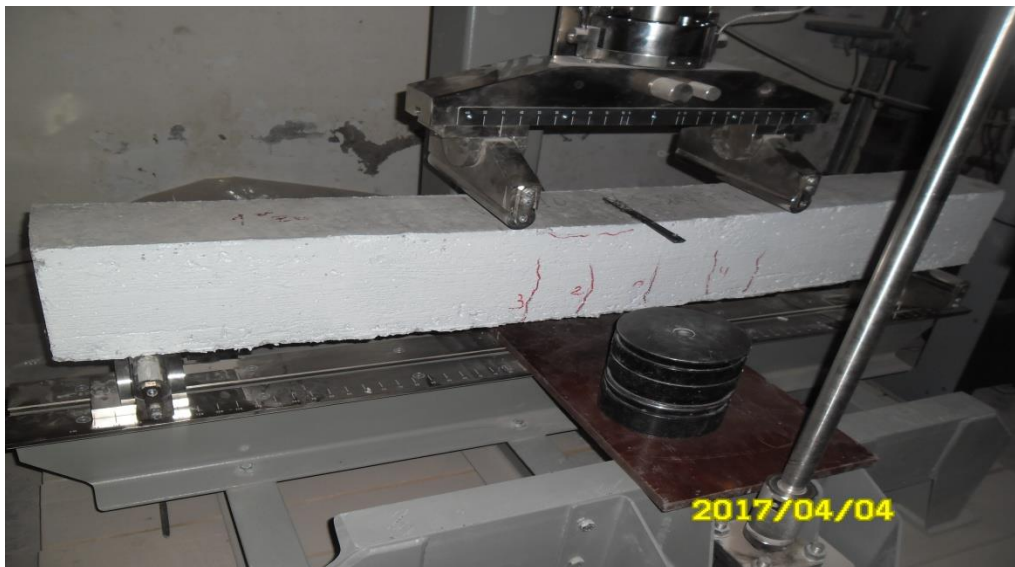
Figure II-14: La propagation des fissures dans la poutre armée
