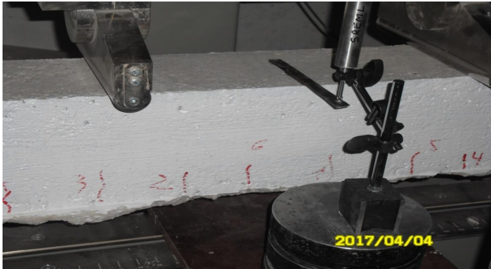
Figure II-13: La disposition de capteur de la flèche
