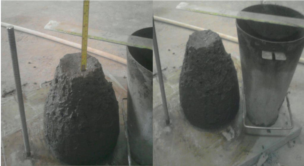
Figure II-2 : L'essai de cône d'Abrams
