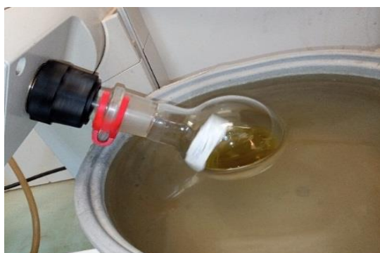
Figure. II-04:l'étape d'évaporation méthanol.
