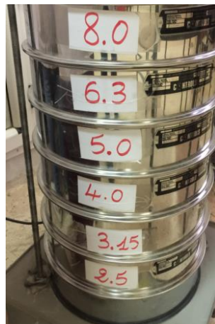
Figure III. 8 : Série des tamis utilisée pour l'analyse granulométrique par tamisage à sec du gravier 3/8.
