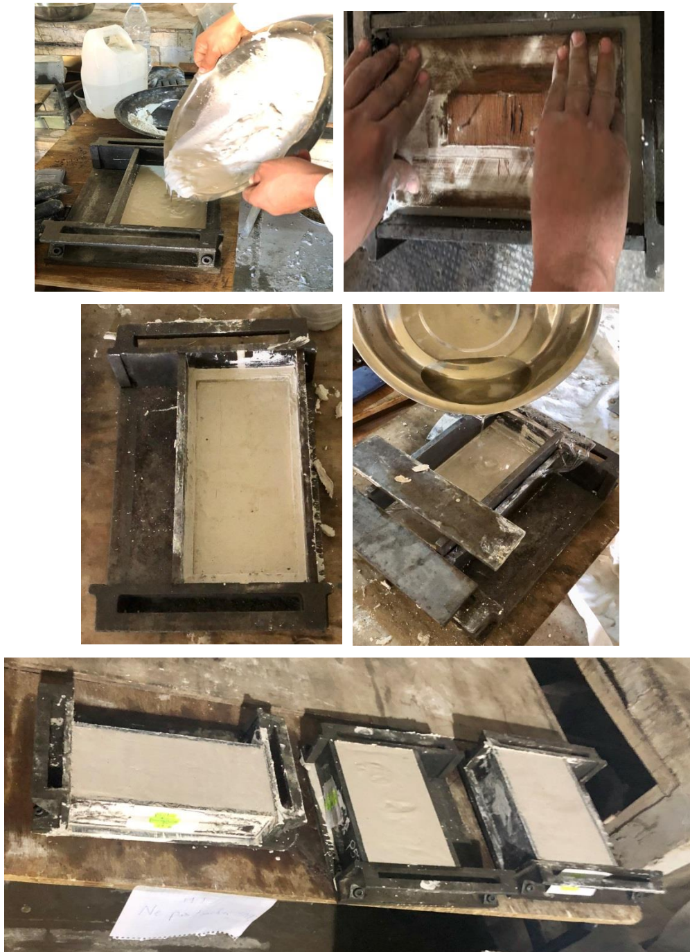
Figure III. 20 : Préparation des plaques de plâtre avec la paraffine.
