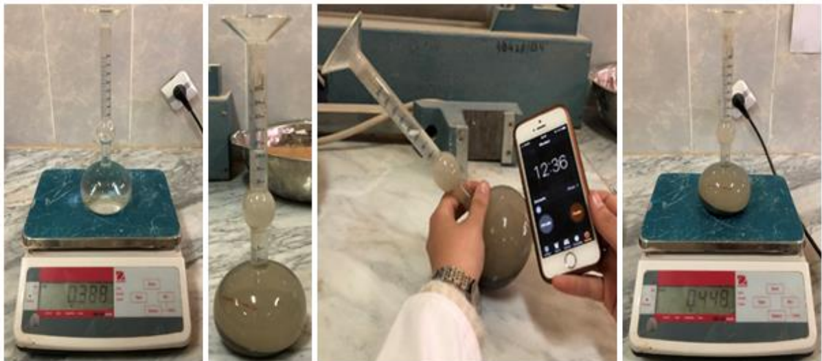
Figure III. 12 : Essai de la masse volumique du ciment utilisé.
