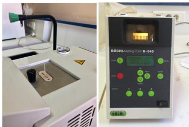
Figure III. 14 : Mesure de la température de fusion de la paraffine 58°.
