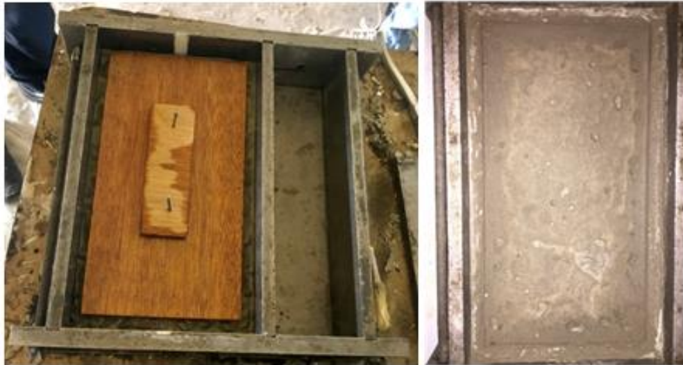
Figure III. 18 : Préparation de l'échantillon avant la mise en place de la paraffine.
