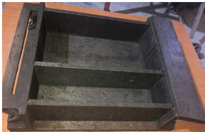
Figure III. 17 : Moule utilisé pour la confection des plaques de béton et de plâtre.
