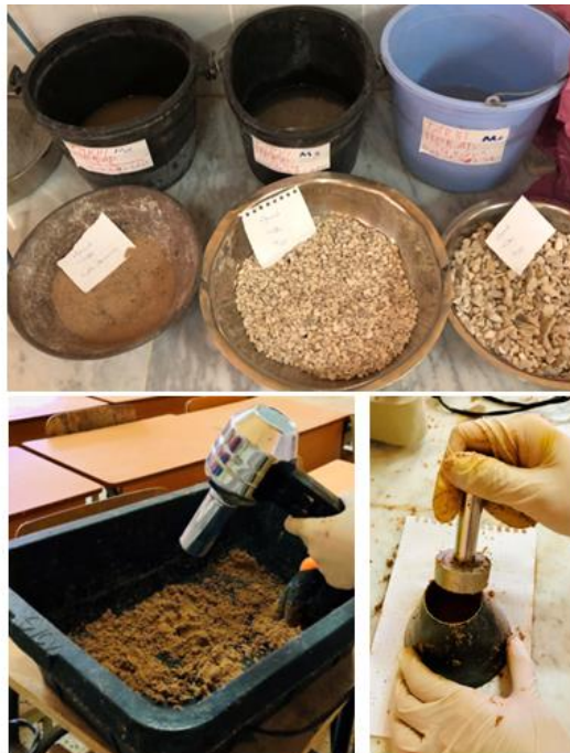
Figure III. 6 : Essai d'absorption des granulats.
