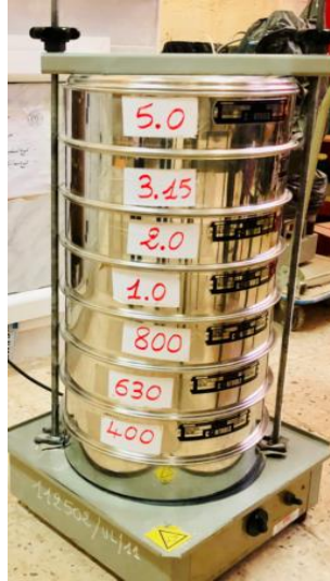
Figure III. 10 : Série des tamis utilisée pour l'analyse granulométrique par tamisage à sec du sable alluvionnaire.
