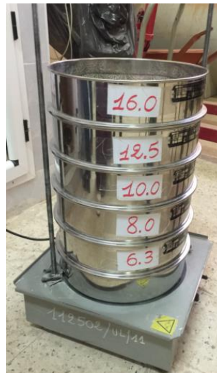
Figure III. 9 : Série des tamis utilisée pour l'analyse granulométrique par tamisage à sec du gravier 8/15.
