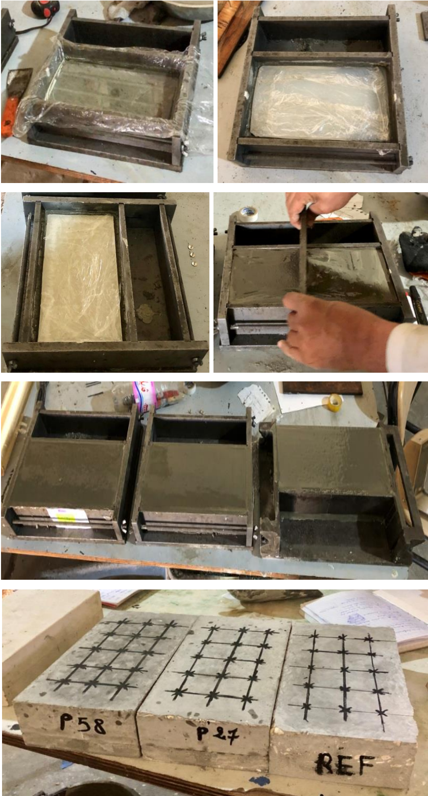
Figure III. 19 : Préparation des plaques de béton avec la paraffine.
