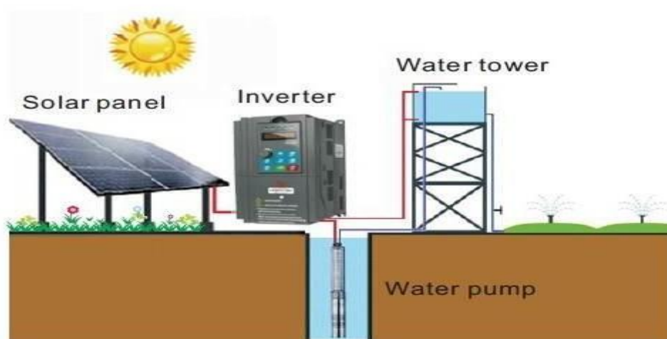
Figure 2.19 Onduleurs solaires pompage.[23]
