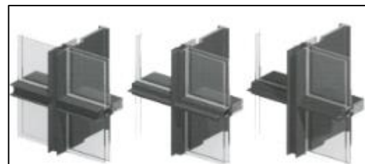
Fig. 15 : Détail d'un mur rideau. [Source : http://www.alu-fac.com ]
