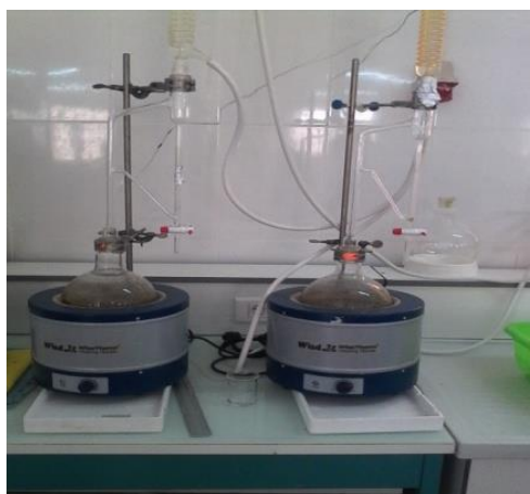
Figure 06 : le montage d'extraction des huiles essentielles (Clevenger) (Photo originale 2018).
