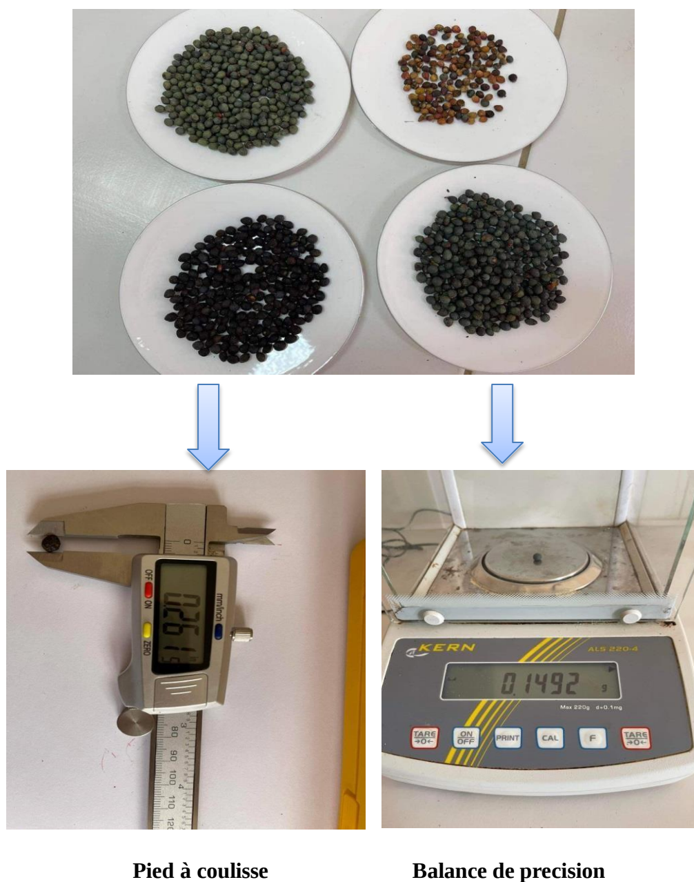
Figure 14 : les étapes de mensuration (poids et diamètres)(Bensalem & Chadouli,2022).
