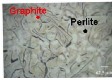
Figure 1-3 : Microstructure d'une fonte EN-GJL-250 à matrice totalement perlitique [7]
