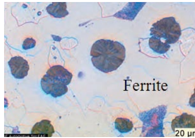
Figure 1-2 : Phase ferritique entourant les sphéroïdes de graphite dans la fonte EN-GJS-400-15 [5].
