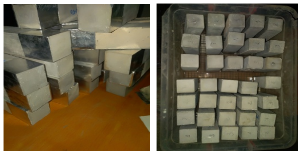
Figure II.7. Dispositif expérimental de l'essai d'absorption d'eau par capillarité.
