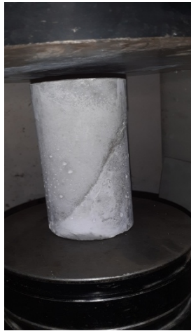
Figure II.11: Forme de composite béton-mortier de l'essai de cisaillement oblique.
