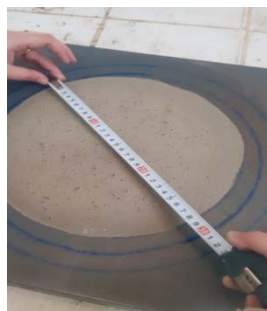
Figure II.5. Essai d'étalement au mini cône.
