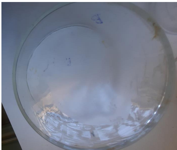
fig.III.3 : Formulation AB film de bonne qualité mais indémoulable.
