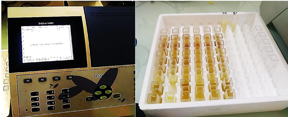
الشكل 22: جهاز قياس الإمتصاصية مع العينات المحضرة للقياس
