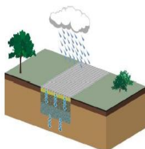
L'infiltration directe (pavés drainants)
