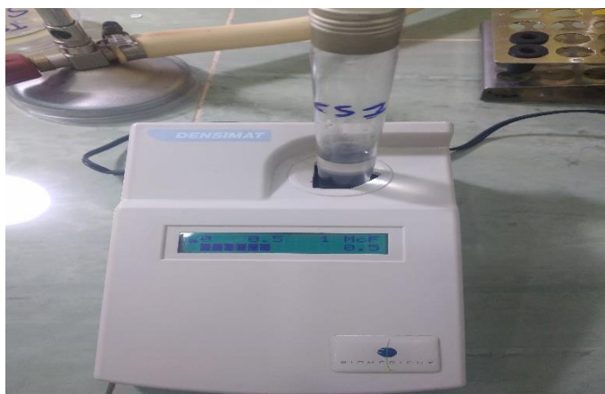
Figure 27: Densitomètre, pour préciser la concentration bactérienne d'une suspension pour la standardisation de l'inoculum (originale 2021).
