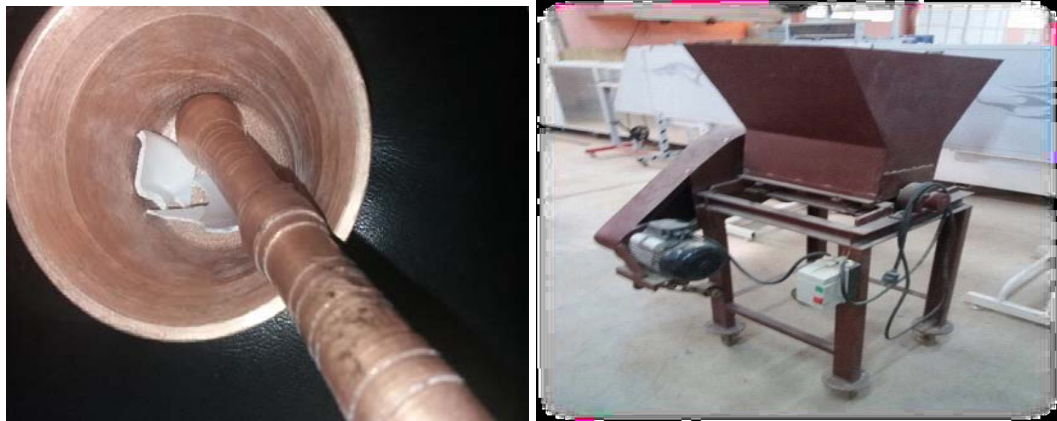
Figure 2.9 : Images montrant le mortier pilon (a-) et broyeur mécanique (b-) utilisés pour le broyage de la Mélamine récupérée.
