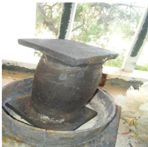
Figure 3.34 : creuset de nitruration après déformation par gonflement
