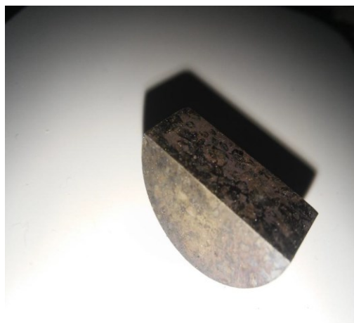
Figure 3.35 : l'échantillon en acier 304L après un traitement de nitruration
