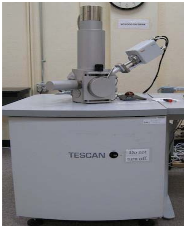
Figure 2.16 : Microscope Electronique à Balayage « MEB » TESCAN du Laboratoire de Génie des Procédés « LGP » utilisé pour métallographie des couches nitrurées.
