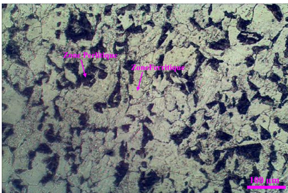
Figure 3.8 : Structure ferrito-perlitique de l'acier S235 avant les traitements de cémentation.
