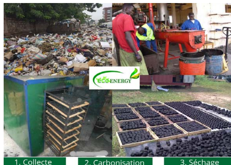
Figure 1.17 : Etapes suivies depuis la collecte jusqu’à la production des briquettes de charbon à partir des déchets organiques à Kinshasa (R.D Congo) [50].
