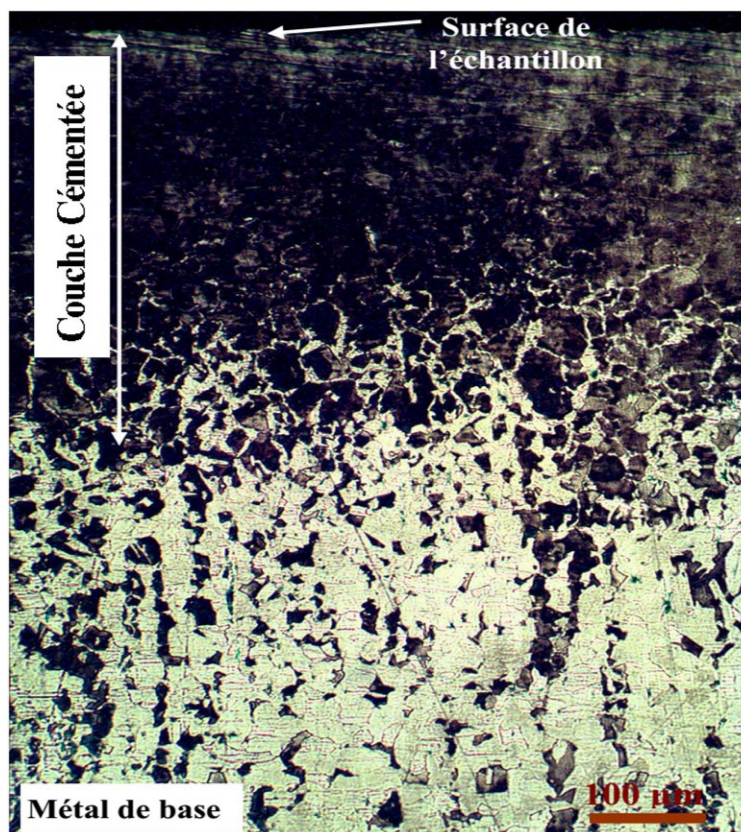
Figure 3.9 : Structure de l'acier S235 après un traitement de cémentation avec le ciment industriel à 920 °C pendant 4 heures
