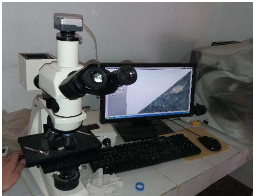
Figure 2.15 : Microscope Optique LIECA DMLM du Laboratoire de Génie des Procédés « LGP » utilisé pour métallographie des couches cimentées.
