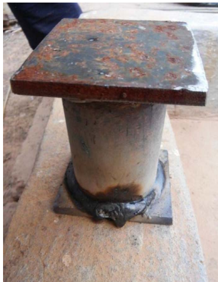
Figure 2.14 : Creuset contenant les échantillons destinés pour les traitements de Nitruration après soudage.
