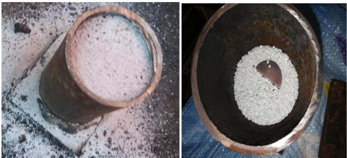
Figure 2.13 : Creuset contenant des échantillons en acier inoxydable 304L destinés pour les traitements de Nitruration plongés dans de la mélaminé récupérée.
