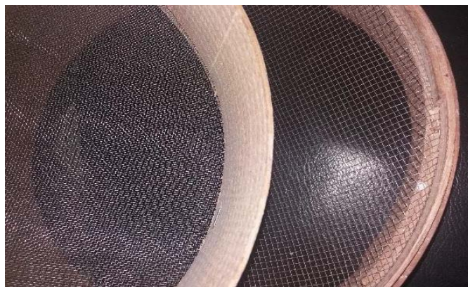
Figure 2.10 : Images montrant les tamiseurs utilisés pour la classification des différentes granulométries de la Mélamine récupérée.
