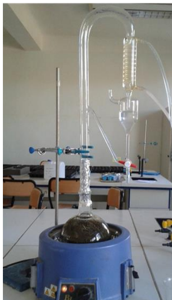
Figure 6 : Montage d'un hydrodistillateur de type Clevenger ( Photo originale, 2020 )
