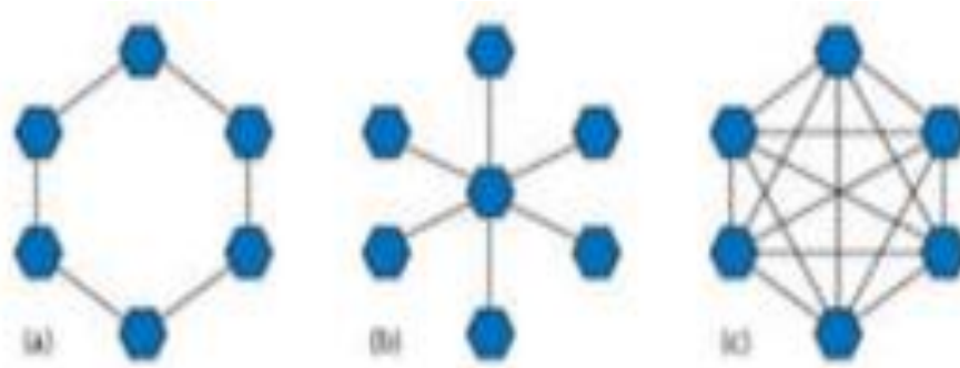
Figure III.5 : Trois topologies du voisinage : (a) anneau (avec n=2 ), (b) rayon, (c) étoile [45].
