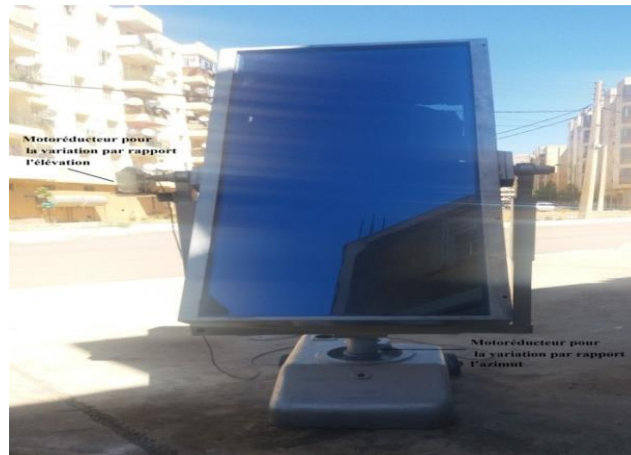
Figure III.5 : Structure mécanique du suiveur solaire [5].
