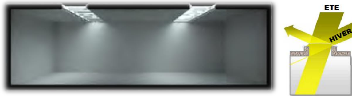
Figure 214 : éclairage zénithale directe (tabatières, verrières)
