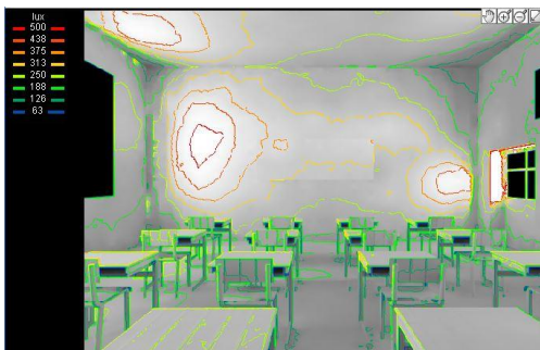
Figure 268 : niveau d'éclairement dans la salle de classe
