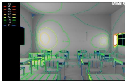
Figure 251 : niveau d'éclairement dans la salle de classe
