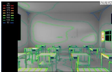
Figure 259 : niveau d'éclairement dans la salle de classe
