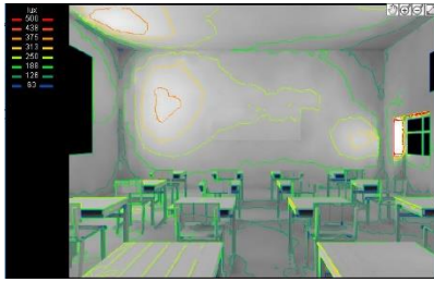
Figure 265 : niveau d'éclairement dans la salle de classe
