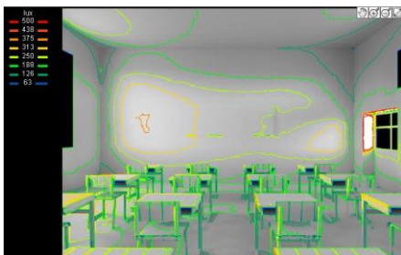
Figure 271 : niveau d'éclairement dans la salle de classe
