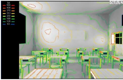
Figure 257 : niveau d'éclairement dans la salle de classe
