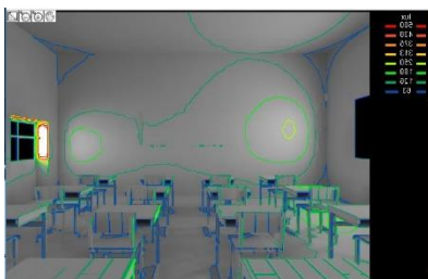
Figure 253 : niveau d'éclairement dans la salle de classe
