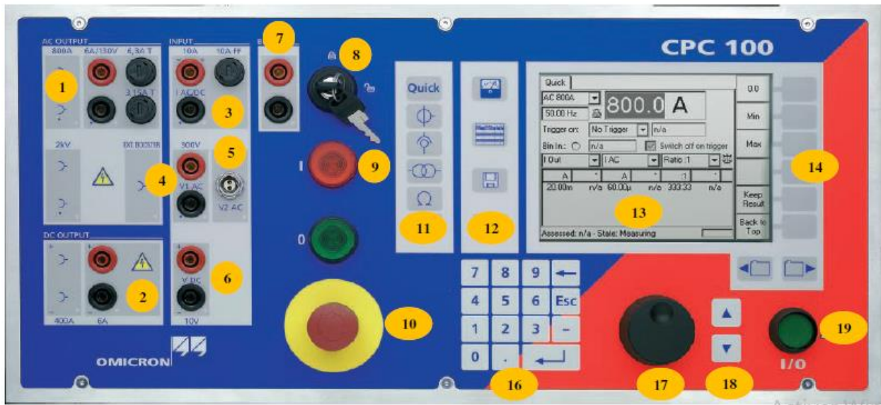
Figure. IV.4. Vue avant de la caisse d'injection Omicron.
