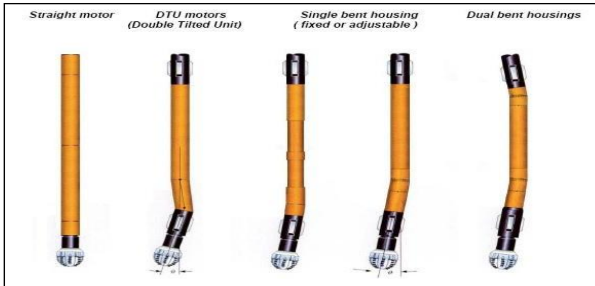
Figure II.5 : Différents types des moteurs & Géométrie des moteurs.
