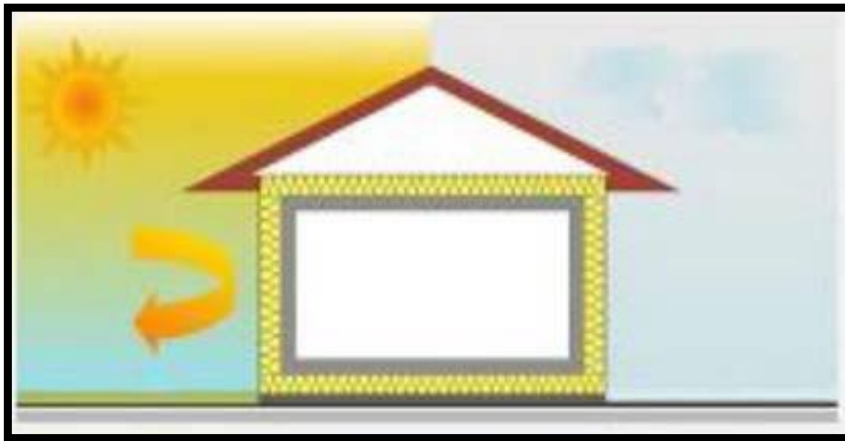
Figure 2.14: L'isolation thermique garde la chaleur dedans en saison froide et dehors en saison chaude Source : Claude-Alain Roulet 2012
