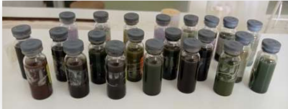
Figure II.7: La dispersion des différentes poudres.
