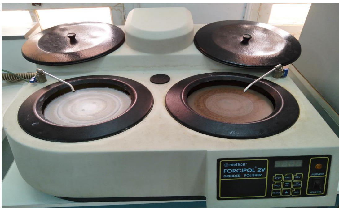
Figure. III.4 : Polisseuse Metkon FORCIPOL 2V
