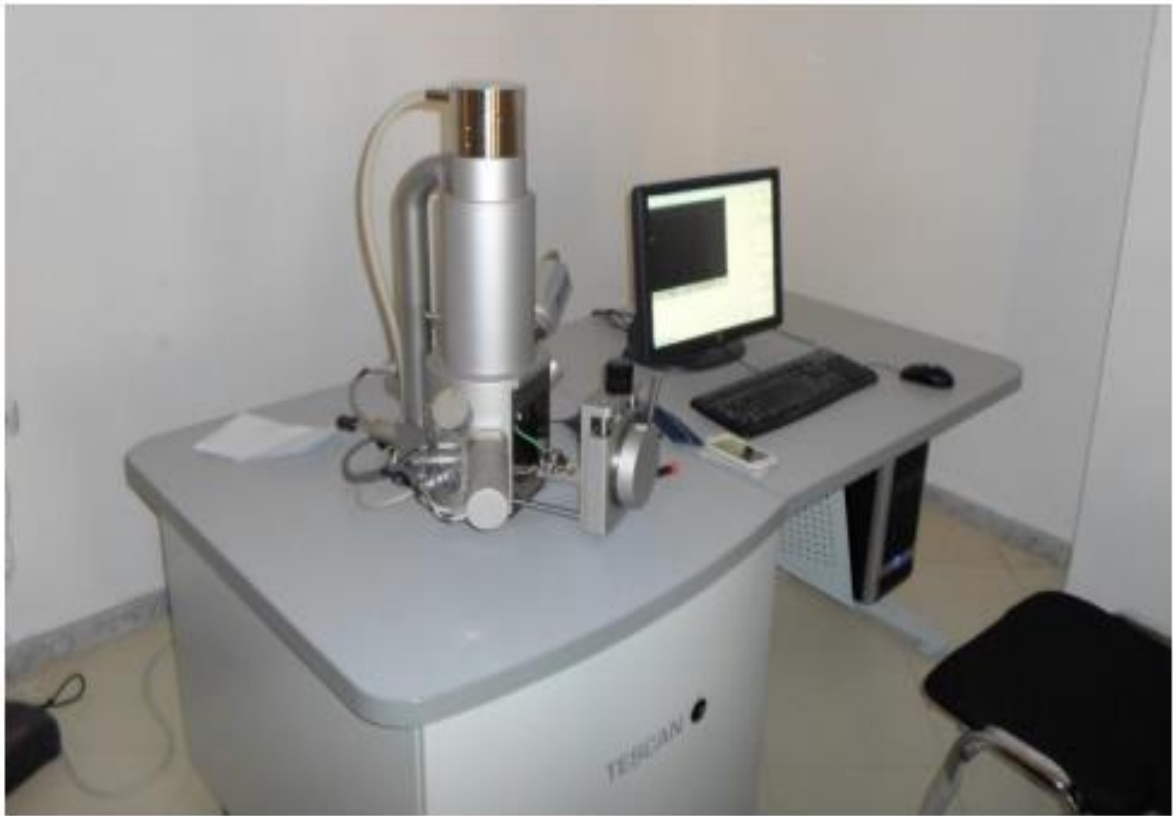
Figure. III.8 : Microscope électronique à balayage (TESCANVEGA3)
