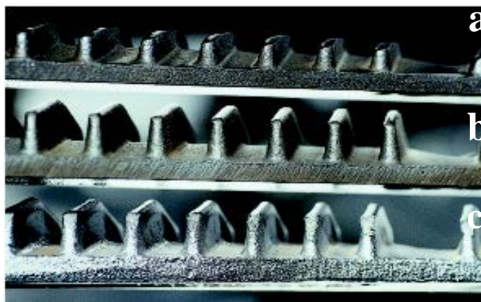
Figure B.5 Usure enregistrée sur une pièce d'une machine agricole en 8630 Steel qui a subi différents traitements de surface. a- après traitement thermique. b- après boruration. c- après chromage dur.
