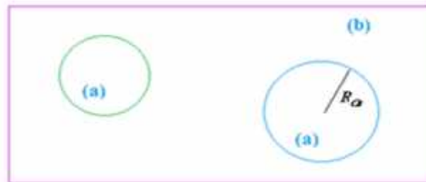
Figure II.1. Répartition de la maille élémentaire en sphères atomiques (a) et en région Interstitielle (b)
