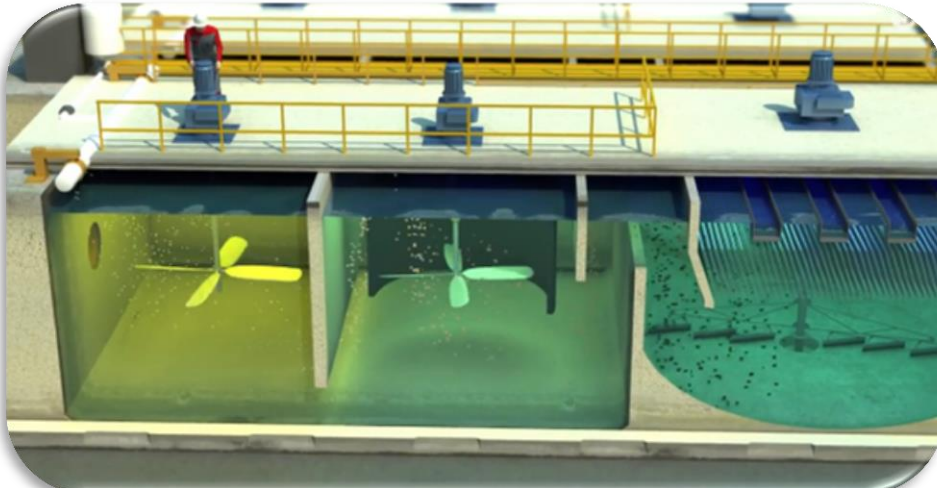
Fig. 98. Une étape de traitement des eaux grises
