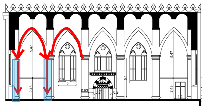
الشكل رقم: III - 19: كيفية تغطية السقف إضافة إلى توزيع القوى في العقود المدببة مصدر : من رسم الطالبة
