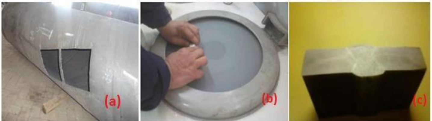
Fig. II.16 : Préparation de l'échantillon. (a) rectification (b) attaque chimique et (c) état finale
