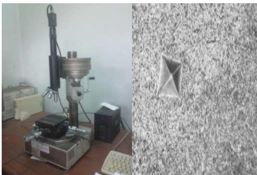
Fig. II.18 : Procédure et machine de dureté (Type Vickers).
