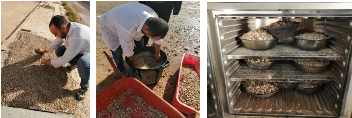
Figure II.1 : Lavage et séchage des échantillons.
