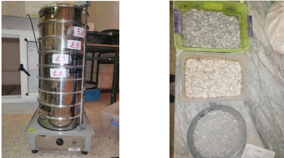
Figure II.2 : Essai de l'analyse granulométrique par tamisage.
