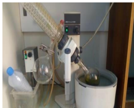
Figure 3: Méthode d'évaporation dans un Rotavapor.
