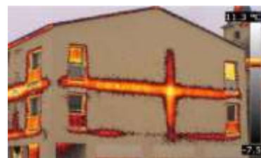
Figure I 06: les positions des ponts thermiques Source : http://www.e-rt2012.fr
