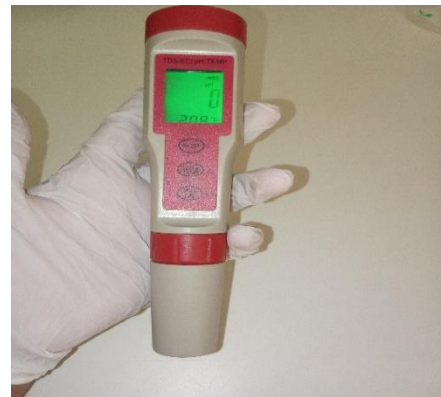
Figure 11 Mesure de TDS/EC/PH/TEMP (photo,2024)
