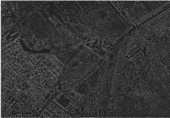
Extraction des contours avec le filtre Laplacien
