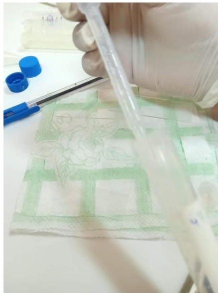
Figure 12 : Aspiration du culot à l'aide d'une pipette après la centrifugation (photo personnelle, 2021)
